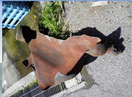
図2-1 破裂した容器
