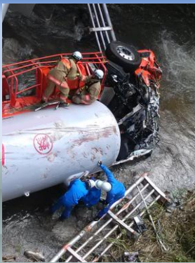
軽油抜き取り作業及びスリップチューブ漏えい閉止作業
