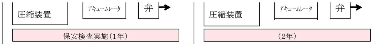
※平成22年度からは、気化器以降の高圧ガス設備が配管及び弁類のみであれば、一体の設備として取り扱うこととします。
