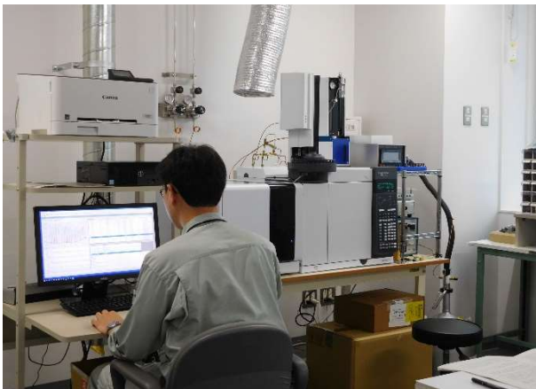
化学物質の分析法開発 (ガスクロマトグラフ質量分析装置)
