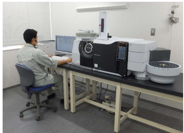
河川水、地下水の分析 （ガスクロマトグラフ質量分析装置）
