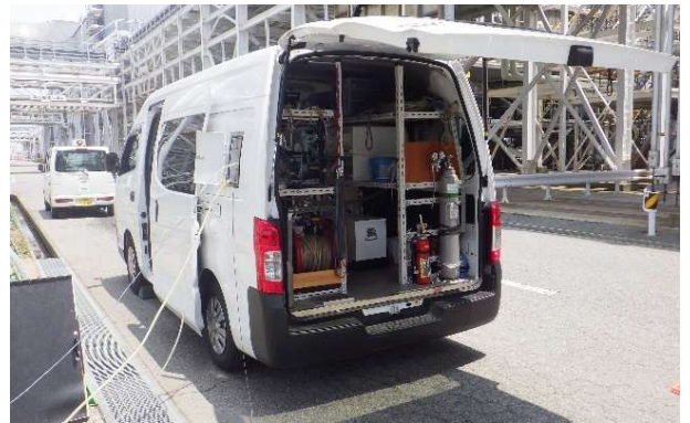
ばい煙測定車による 工場・事業場排出ガスの調査
