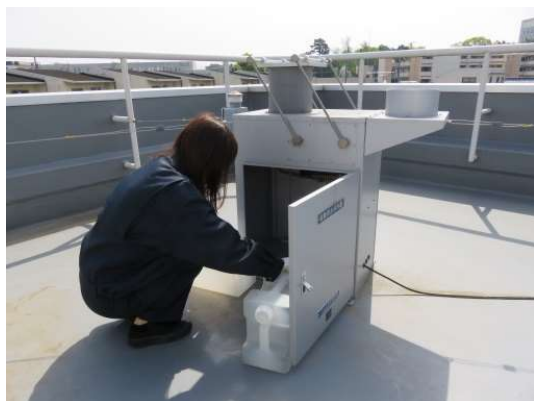
酸性雨調査（雨水自動採取装置）
