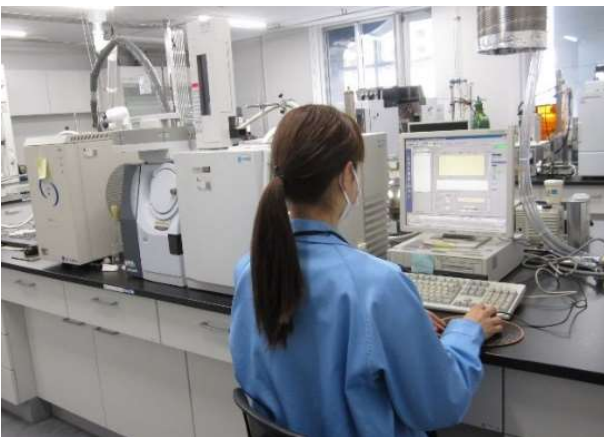
トルエン等の化学物質の分析 (ガスクロマトグラフ質量分析装置)
