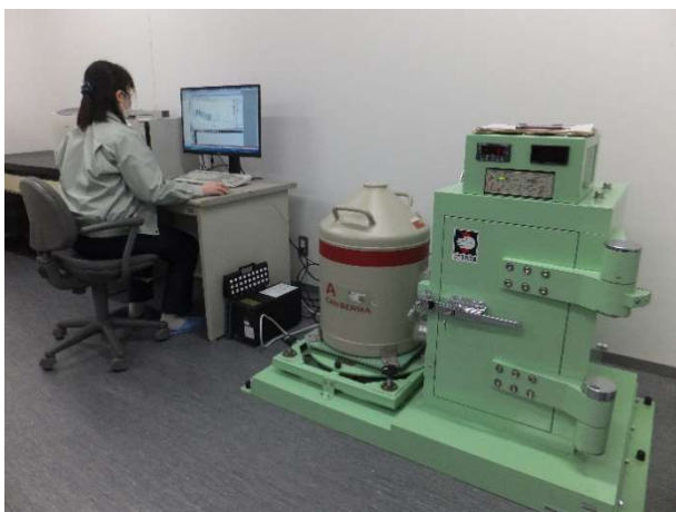
放射能の分析 (ゲルマニウム半導体核種分析装置)
