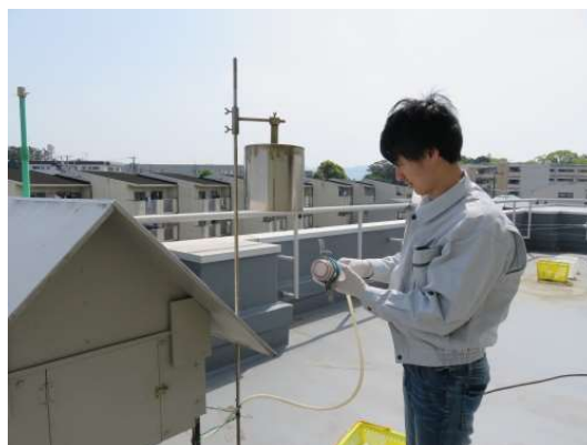
酸性雨の調査（乾性沈着物サンプリング）
