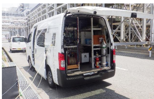
ばい煙測定車による 工場・事業場排出ガスの調査
