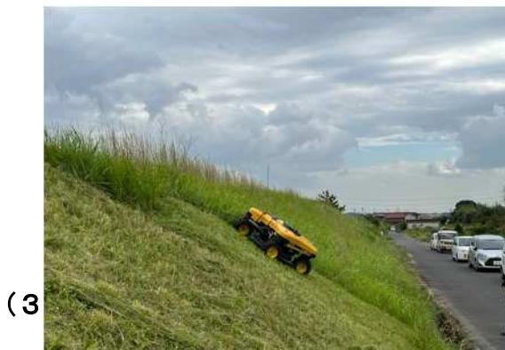
図表3-1-42 ラジコン草刈り機を用いた 畦畔管理の実証
