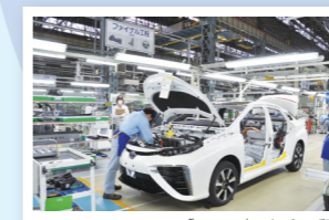
FCV [MIRAI]の組立工程
