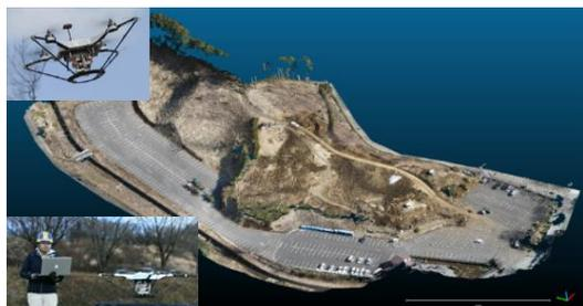
ドローン等による写真測量等により、短時間で面的(高密度)な3次元測量を実施。
