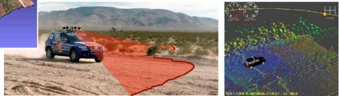
距離センサによる道路領域検出 [Thrun JFSR-2006]
