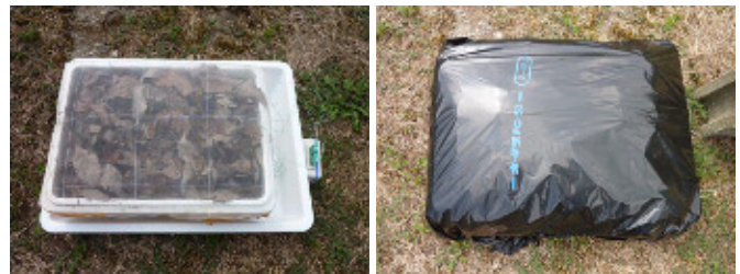
写真-2 網(左)とマルチシート(右)で覆った状態
