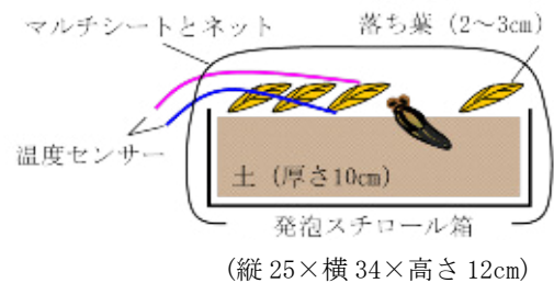
図-1 太陽熱を利用したナメクジ駆除実験装置
