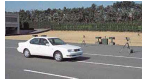
加速・定常走行騒音試験の状況 (試験コースが必要)
