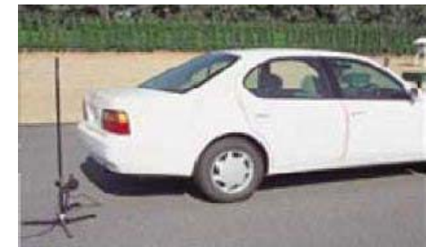
近接排気騒音の試験の状況 (試験コースは必要なし)
