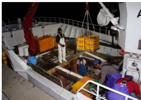
油圧クレーンによる搬出作業の軽労化
