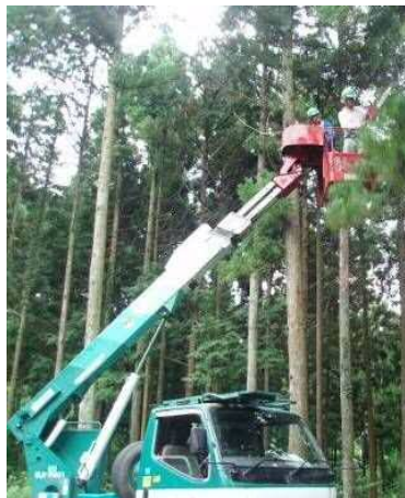
高所作業車を用いた枝払
