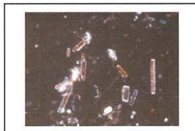
アンソフィライト (屈折率 n_D^{25^\circ C} : 1.618 )
