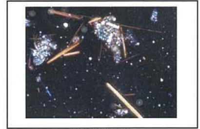
クロシドライト (屈折率 n_D^{25^\circ C} : 1.680 )
