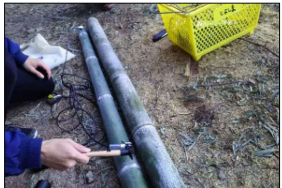
タケの応力波伝播速度による現場仕分け
