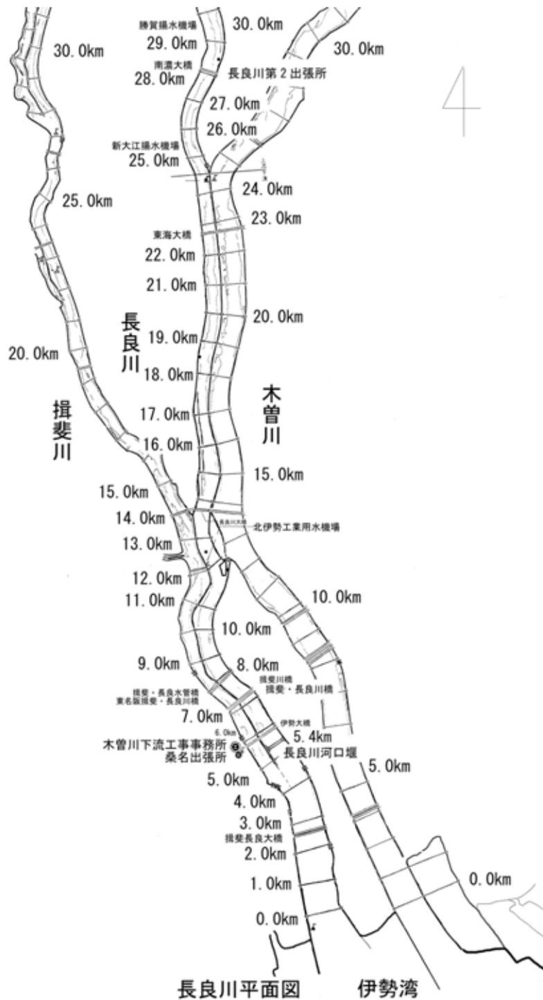
2,400万 $m^3$ という土量は, 30km区間に亘って低水路幅200mを掘削した場合, 河床の切り下げ深さが4mにも及ぶ膨大な量
