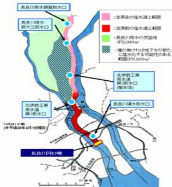
図4 - 10 浚渫による塩水の遡上と地下水の浸透
