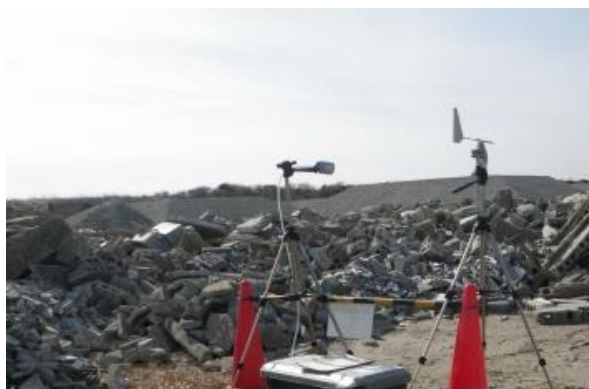
アスベスト大気濃度調査の例（仮置場）
