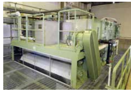
③ ベルトプレス脱水機 通常、嫌気性消化汚泥は難脱水汚泥であり高含水率の脱水ケーキとなりますが、濃縮部へ新開発機構を採用することにより凝集剤が均一に混合され、低含水率の汚泥ケーキを実現します。
