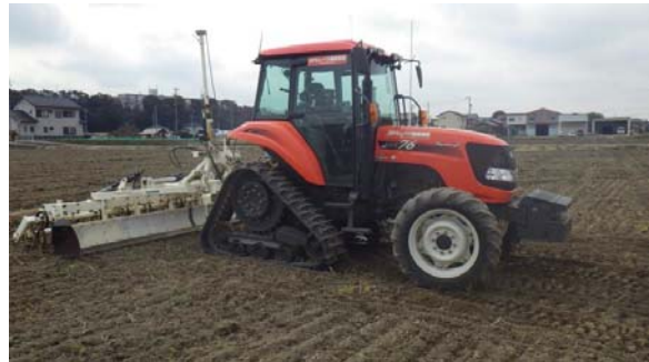
GPS レベラーを装着したトラクター
