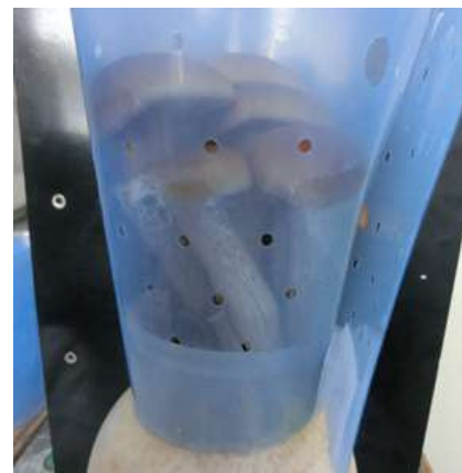
写真-1 巻筒による試験
