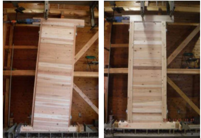
写真-2 大壁式(左)と真壁式(右)の試験状況
