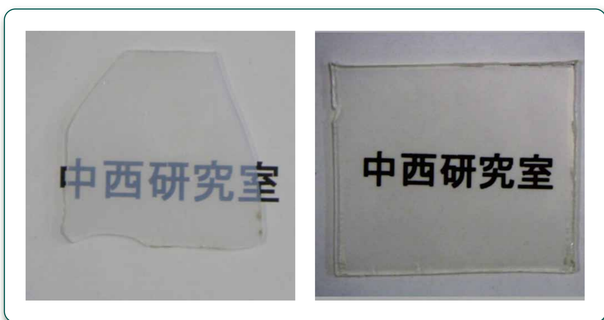
図1 開発した有機-無機複合材料 左:未処理シリカを用いた複合材料 右:表面処理シリカを用いた複合材料
