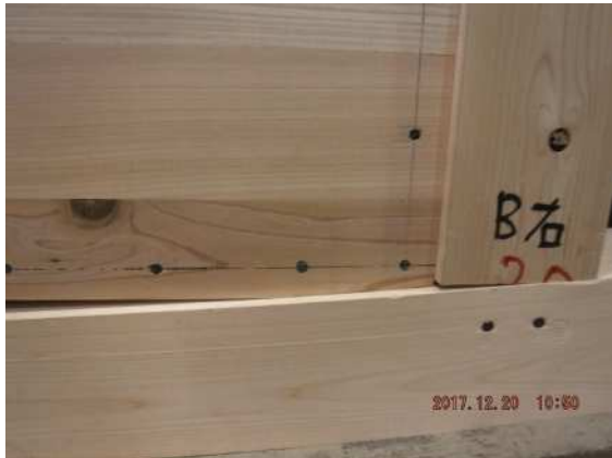
写真-16 パネル木口の土台へのめり込み (GN75@100mm)
