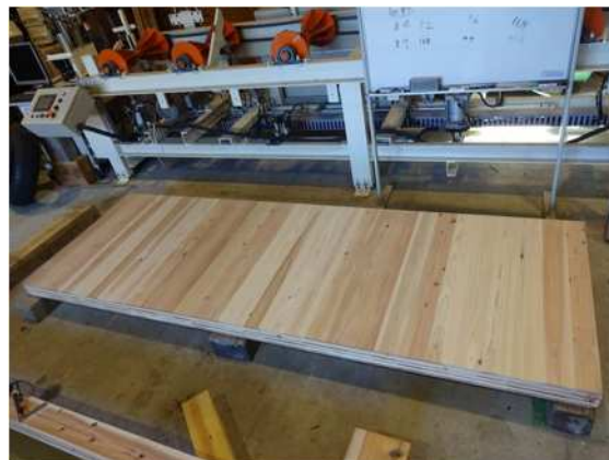
写真-1 スギ2層パネル表面
