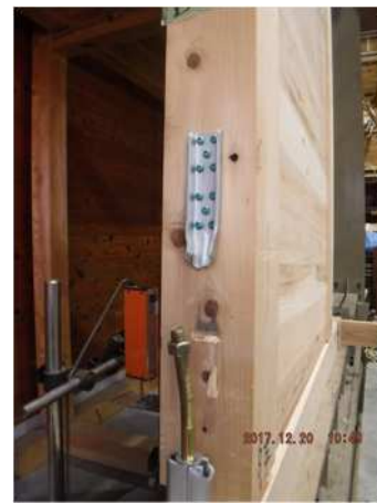
写真-15 CN75@100mm ホールダウン破断状況
