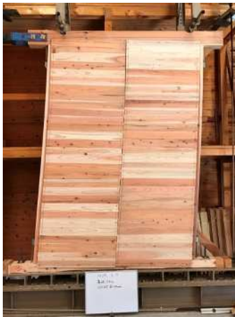
写真-7, 8, 9 パネル板材相互間すべりの状況 (左、中央 : CN65@100mm、右 : N65@75mm)
