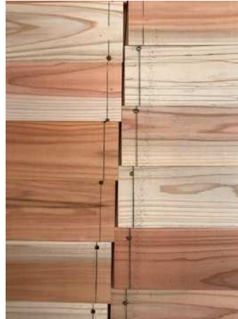
写真-7, 8, 9 パネル板材相互間すべりの状況 (左、中央 : CN65@100mm、右 : N65@75mm)
