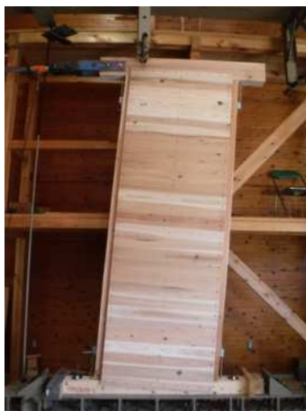
写真-10 CN75@100mm (柱スギ) 試験体 1/15rad 時状況
