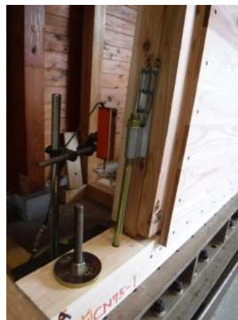
写真-11 柱割裂状況 CN75@100mm (柱スギ) 1 体目
