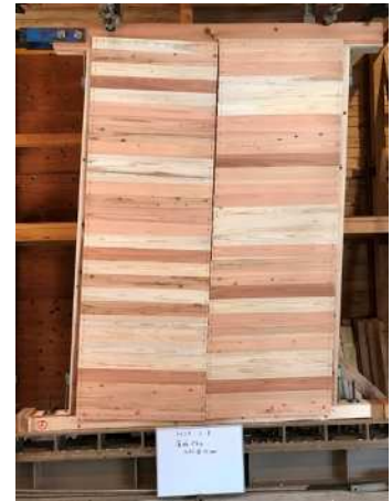
写真-7, 8, 9 パネル板材相互間すべりの状況 (左、中央 : CN65@100mm、右 : N65@75mm)
