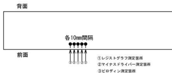
図-4 現地劣化状況調査の測定位置
