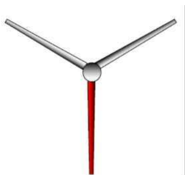
図-10 1枚のブレードの彩色例 (赤色、根元から先端部彩色)
