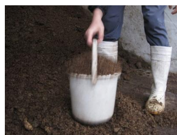
③ バケツを 10cm の高さから 10 回落とす
