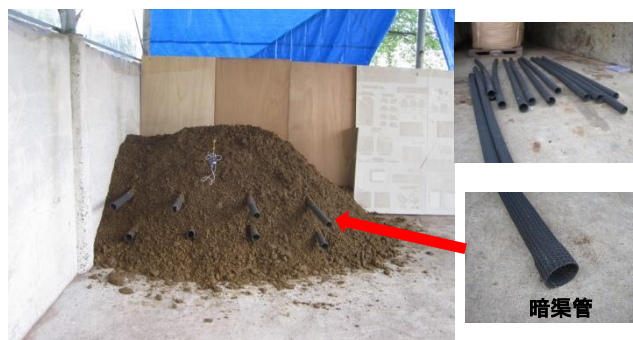
暗渠管の埋設による堆積物の通気性の改善
