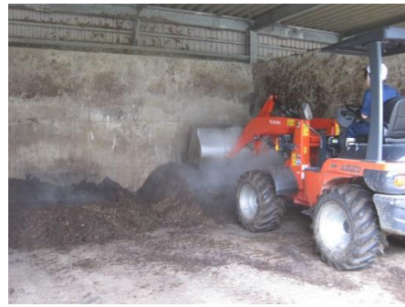
切り返し作業（ホイールローダーにより堆肥を攪拌する）
