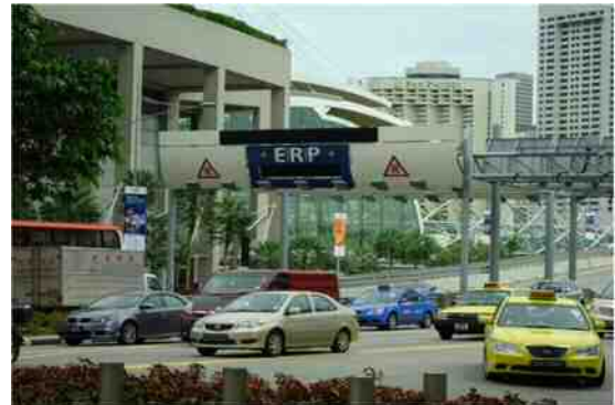
シンガポールのロードプライシング (Electronic Road Pricing) 写真提供：三菱UFJリサーチ&コンサルティング
