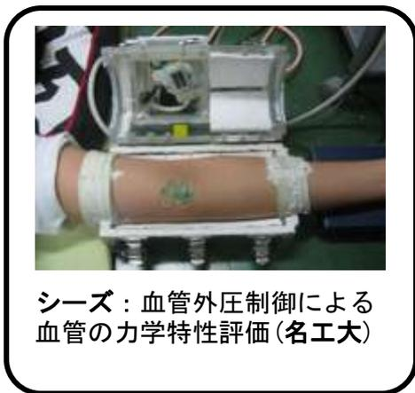
シーズ：血管外圧制御による血管の力学特性評価(名工大)
