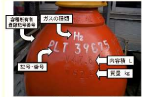
高圧ガス容器の刻印
