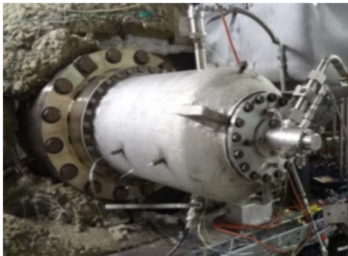
M1A-17 拡散燃焼器 水素専焼/混焼，水噴射試験 (アーヘン工科大学)
