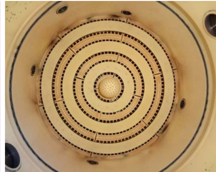
2時間の試験後の燃焼器内部
