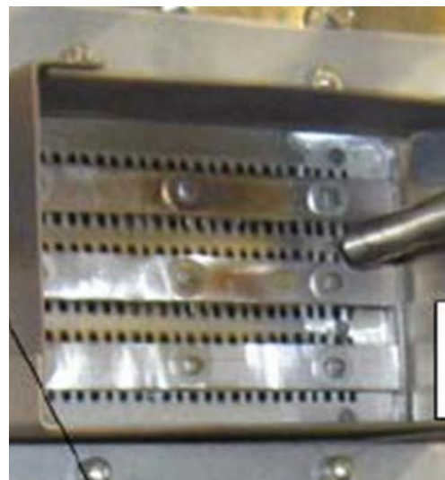
小型試験バーナを用いた水素燃焼試験 (FHアーヘン大学)
