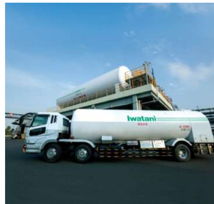
液化水素トレーラー
