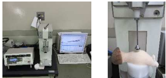
写真-1 クリープメータによる硬さの測定
