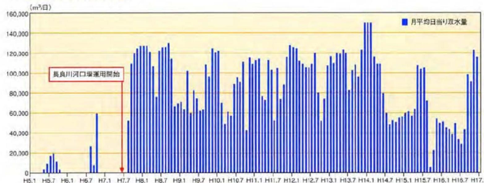
北伊勢工業用水道第二期：長良川自流、三重県は上流部岐阜県側での取水を希望したが、岐阜県が反対したため、第一取水口（千本松原）で開始。塩水が遡上するため、第二取水口（森下）を設置し、冬季には使用。河口堰完成後、老朽化した第二取水口を撤去して、第一取水口で耐震工事を実施。
