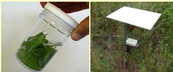
エタノール洗浄法（左）および湿式トラップ（右）
