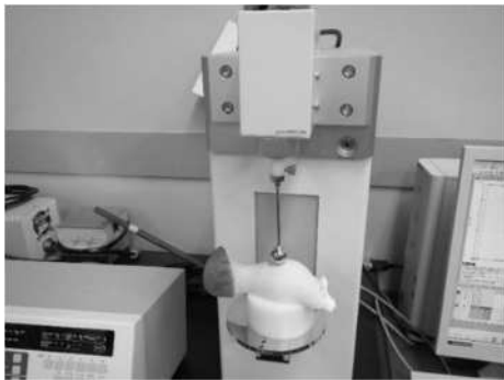
写真-1 クリープメータによる測定
