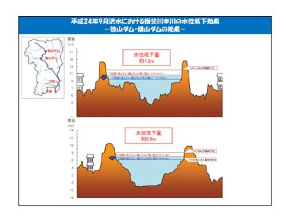
この評価で疑問なのは、徳山ダム・横山ダムがない場合の水位の推定にいつの時点の河床高を 用いたのかである。ダムがなかったとすれば出水時の河床はどうであったかをどのように推定し たかである。
