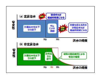
堤防補強により河道の流下能力の「実力」が大きくなるうえ、越水しても河川は流下機能を直 ちにまったく失うわけではないので、「安全性」も一部は維持される。
