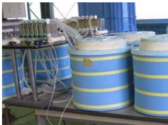
図3 10 L容積小型堆肥化装置
