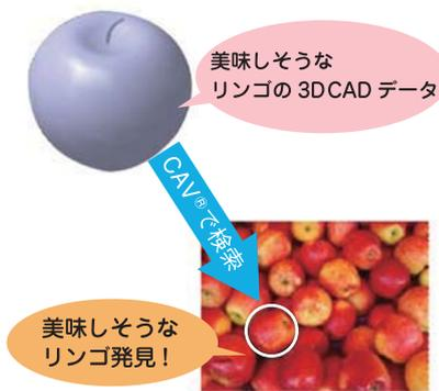
た検査対象物の画像や動画画像に対して、様々な角度からの3D CADデータ元に撮影画像を比較して合致判定します。このプロセスは人間の記憶による物体の判別と似ています。人間は記憶によって様々な角度の物体の形状を頭の中で描くことができます。CAVも同様に3D CADデータから様々な角度の製品の仮想画像を作成することができます。様々な角度で撮影された検査対象物を本物かどうか判別します。CAVは「人の目視検査をデジタル化する」をコンセプトに開発した次世代3Dエンジニアリング技術なのです。
