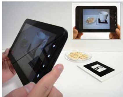
実像の上に虚像（シミュレーション画像）を重ね合わせるAR技術
