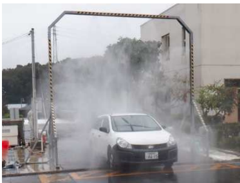
家畜伝染病防止のため畜舎入口に設置された車両消毒装置
