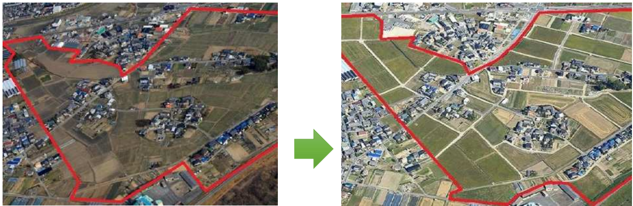
基盤整備による農地の大区画化（右：整備後）
