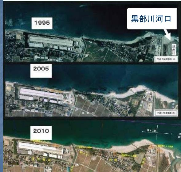
排砂による土砂供給により、侵食された海岸が回復してきている
