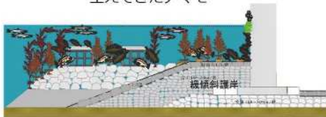
緩傾斜護岸化による藻場造成
