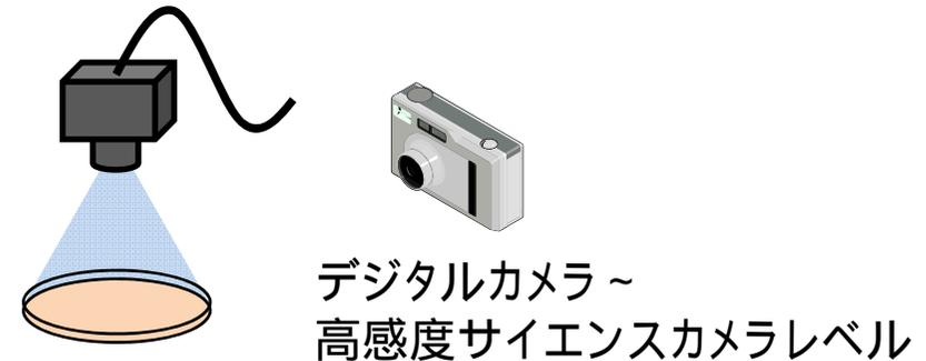
プレート全体の観察の場合1800万画素のカメラを用いても、測定範囲の下限が25  $\mu\text{m}/\text{pixel}$ になる。
