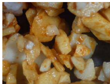
<洗浄・消毒前の汚れたろ材>
