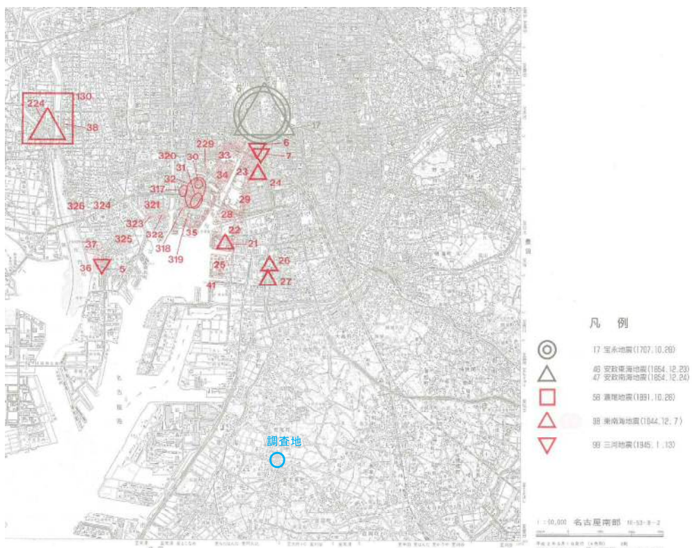
図 5.2 調査地周辺における液状化の履歴（出典：日本の地盤液状化履歴図 東京大学出版会）
