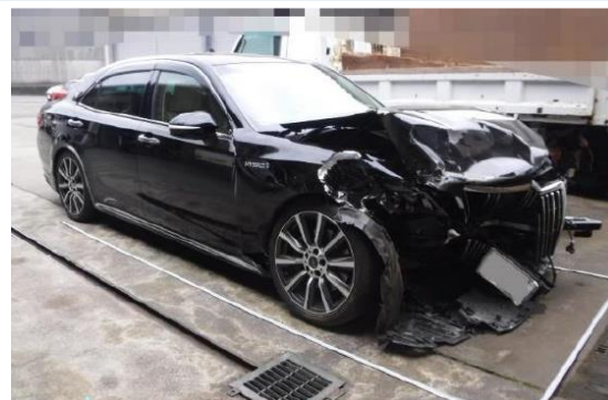
車両Bの変形状況
