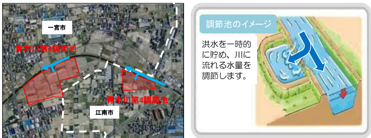
⑥-1 青木川中流：第3・第4調節池予定箇所及び調整池に洪水を貯留するイメージ
