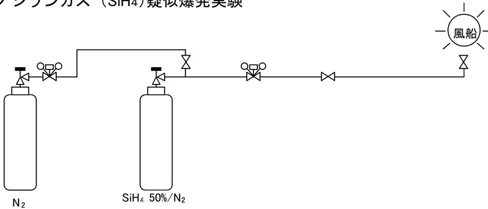
モノシラン燃焼実験概要図
