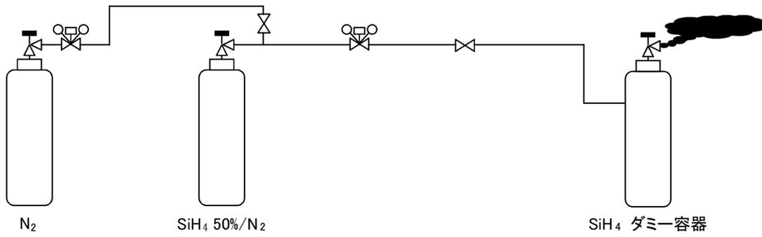
②モノシランガス (SiH<sub>4</sub>)水中バブリング実験
