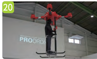
20 対話型パッセンジャードローン「SUKUU」 対象者を載せて安全地帯まで避難。モニターによって、オペレーターと常にコミュニケーションをとることが可能となり、安心感を与えつつ移動を遂行。 (株)プロドローン
