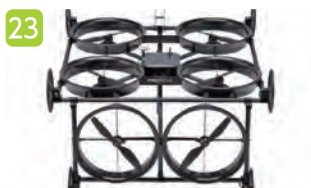
23 壁をよじ登る自走式張り付き型ドローン「PD6-CI-L」 橋梁検査のみならず、一般建築物の壁面検査等にも幅広く使用することが可能。 (株)プロドローン
